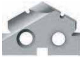
Placchetta NC (HSS-E/HSS-E-PM o MD) con angolatura a 90° o 120° (l'angolo di 90° della punta viene deformato secondo il Ø della placchetta).
